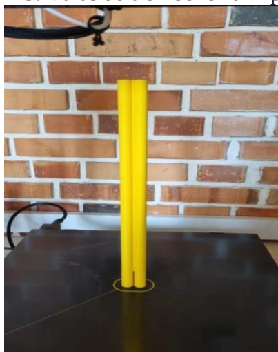
Imagem 3: Varas do trombone na impressora
